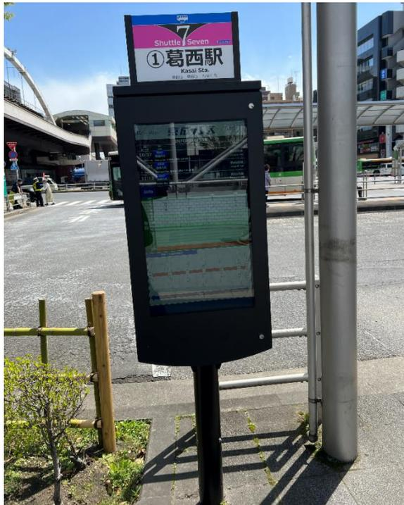
今回導入したスマートバス停は、31.5インチの液晶画面にバスの接近情報や時刻表、緊急性の高い運行情報(運休、大幅な遅延)等を大きく表示することが可能なデジタル式バス停で、当社が推進する多言語対応の一環として4か国5言語(日・英・簡・繁・韓)に対応しています。お客様の視認性の向上だけでなく、インバウンド旅行者への案内強化が図られます。
