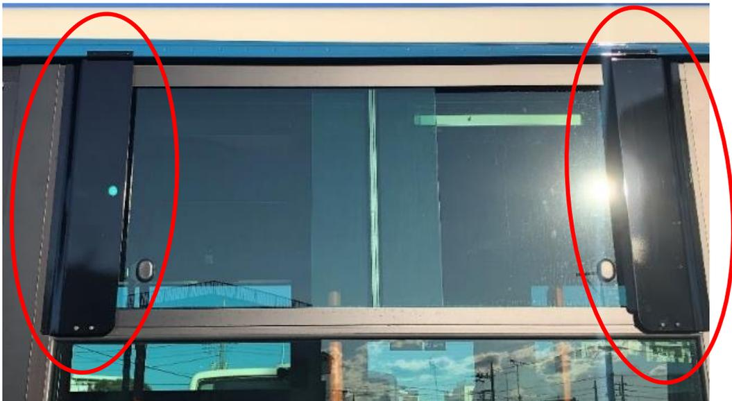
【雨除けバイザーの取付け例】
